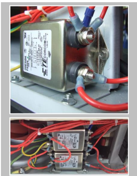
Övre bilden: ett EMC-filter (1000 W e2s-varianten) Nedre bilden: två EMC-filter (2000 W e2s-varianten)
